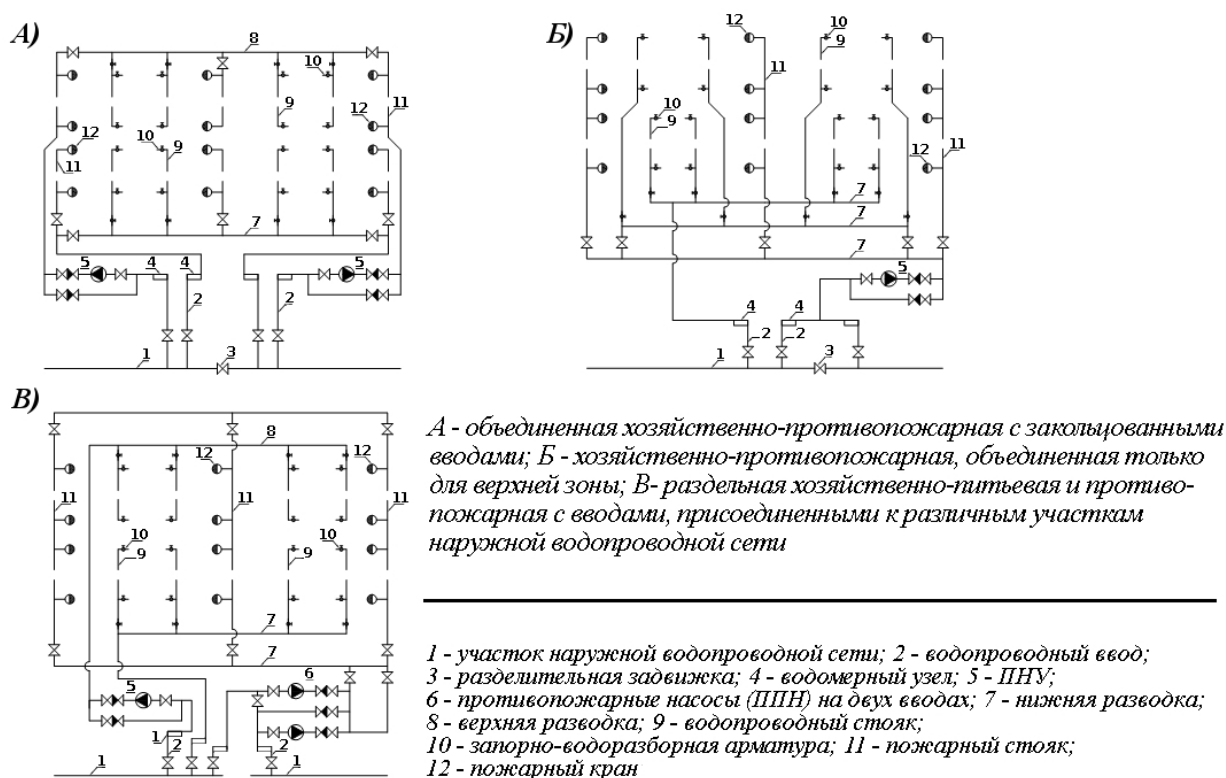
Рисунок 2 – Схемы зонных систем внутренних водопроводов зданий с ПНУ
