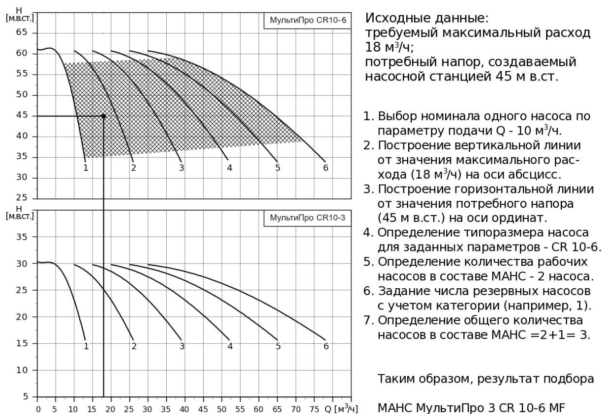
Рисунок 8 – Подбор ПНУ на рабочую точку ( Q, H )
