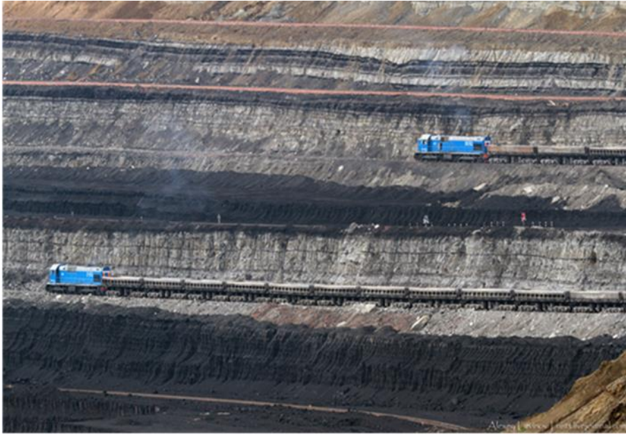
Рис. 13. Бородинский угольный разрез в Красноярском крае. Цикличность образования слоев угля и алевролитовых прослоев
