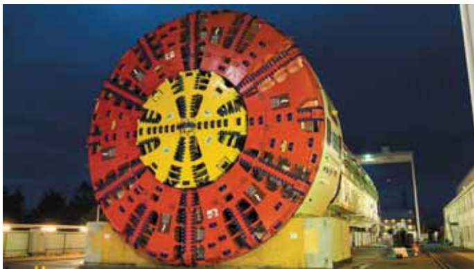
Рис. 212. Тоннелепроходческий механизированный комплекс Herrenknecht
