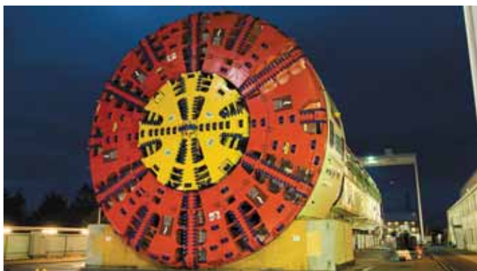
Рис. 212. Тоннелепроходческий механизированный комплекс Herrenknecht
