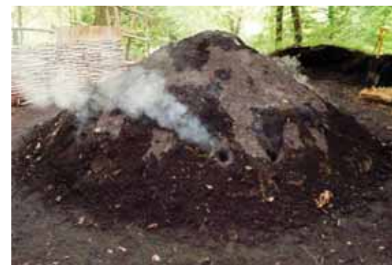
Рис. 30. Завершающая стадия получения древесного угля
