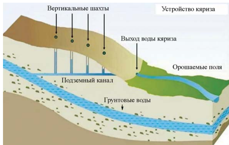
Рис. 30. Конструктивная схема кяриза
