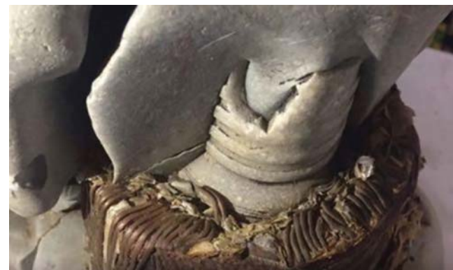
Рис. 79. Остатки медных проводов на трансформаторе
