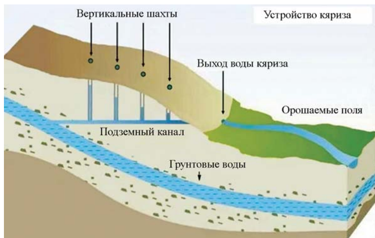
Рис. 30. Конструктивная схема кяриза
