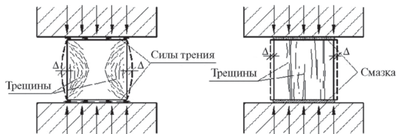
Рис. 366. Образование и развитие микротрещин и макротрещин при сжатии бетонного куба (при наличии сил трения по горизонтальным поверхностям куба и при их отсутствии)
